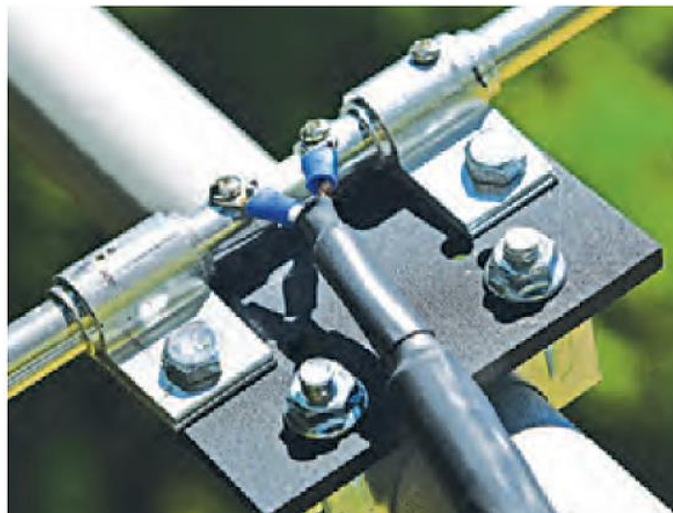
Rys. 5.3.4. Montaż wibratora do nośnika z uwzględnieniem podłączenia kabla i symetryzatora
