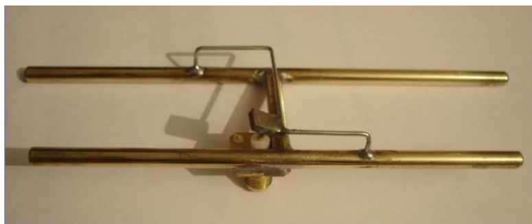
Fot. 2.1.8. Wykonanie anteny DH2PA na pasmo 23 cm, długość reflektora 112 mm, direktora – 103 mm, TR – 19 mm, TD – 17,5 mm, odstęp 27 mm. Linia fazująca wykonana z przewodu 1 mm, elementy mają średnicę 4 mm, odstęp przewodu fazującego 4,5 mm. Kondensator o pojemności ok. 4 pF wykonany z laminatu dwustronnego o wymiarach 6 x 7 mm
