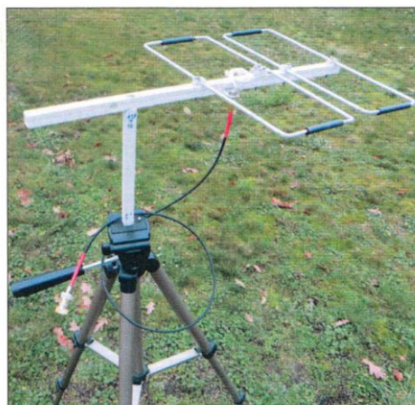
Fot. 5.3.5. Wykonanie anteny OE1WKL
