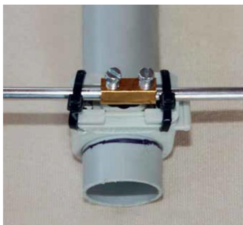
Fot. 5.3.12. Montaż połówek reflektora (źródło: Funkamateur)
