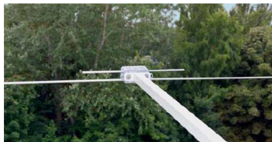
Fot. 5.4.8. Widok anteny na plastikowym nośniku
