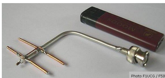
Fot. 2.1.9. Wykonanie anteny F1UCG/F5IF na pasmo 2440 MHz. Długość reflektora wynosi 60 mm, direktora – 55 mm, odstęp między nimi 15 mm. Przewód linii fazującej jest przylutowany w odległości 8 mm od środka i odległy o 2 mm od elementów. Sztywny kabel zasilający stanowi jednocześnie nośnik anteny, a elementy wykonano z przewodu o przekroju 4 mm 2
